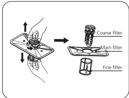
Filhačný systém pozostáva z hrubého filtra, plochého (hlavného) filtra a mikrofiltra (jemného filtra).
