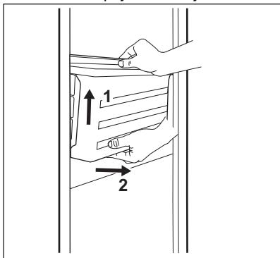
4. Zatlačte kolejničky dovnitř skříně, abyste zabránili poškození spotřebiče při zavírání dveří.
