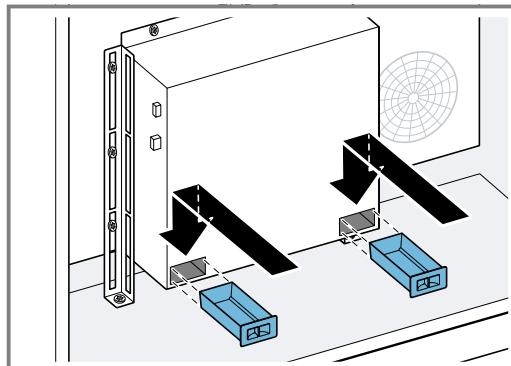
14. Zapojte kabely do tělesa ventilátoru.
