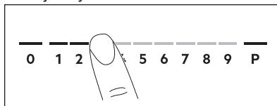
Keď položíte na zónu riad a nastavíte varný stupeň, zostane nezmenený do 2 minút od odobratia riadu. Ovládaci pásek a ukazovateľ varnej zóny blikajú 2 minúty. Ak opäť položíte riad na varnú zónu v rámci tohto času, opäťovne sa zapne varný stupeň, inak sa varná zóna vypne.
