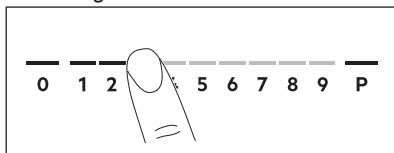
După ce ați pus un vas pe zonă și setați nivelul de căldură, acesta rămâne la fel timp de 2 minute după ce îndepărtați vasul. Bara de comandă și indicatorul zonei de gătit clipesc timp de 2 minute. Dacă puneți din nou vasul pe zona de gătit în acest timp, nivelul de căldură se reactivează, altfel, zona de gătit se dezactivează.
