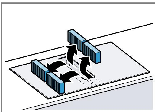
4. Vložte 2 pachové filtre alebo akustické filtre vľavo a vpravo do spotrebiča a posuňte dopredu.
