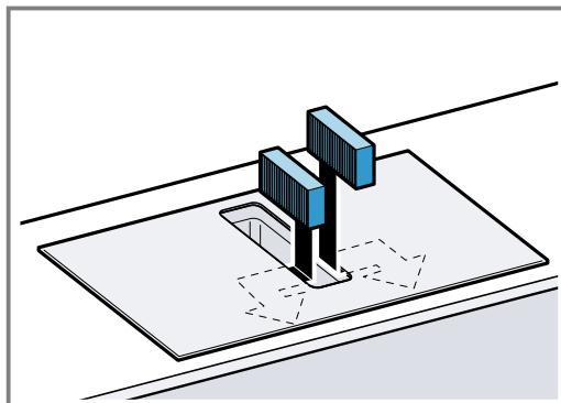
5. Vložte ďalšie pachové filtre alebo akustické filtre vľavo a vpravo do spotrebiča a posuňte dopredu.
