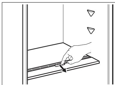
Chcete-li zařízení pro regulaci vlhkosti vyjmout, otevřete zásuvku pod skleněnou polící a vytáhněte kryt.
